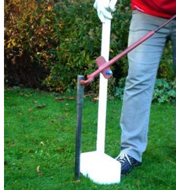
Ziehvorgang des Bohrstocke
