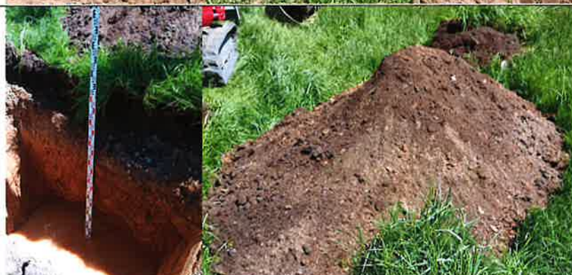
Baggerschurf BS 2 links: Schurfprofil rechts: Aushub Auffüllung Aufnahme: 02.06.2021
