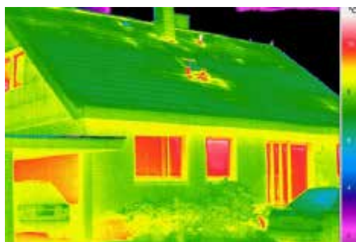
Aufnahme eines Wohngebäudes mit einer Thermographie-Kamera. https://www.senden-westfalen.de/de/wirtschaft-bauen/klimaschutz-energie/aktiv-fuers-klima
