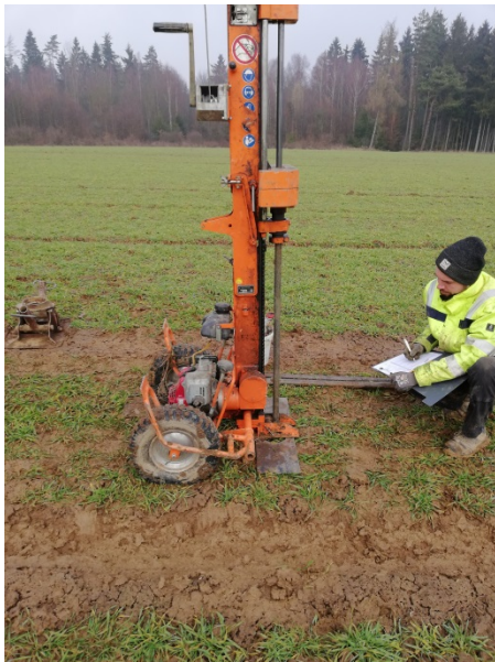
Schwere Rammsondierung DPH
